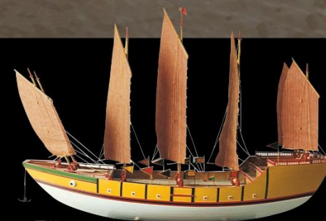
馬船 長度：37/104.7(丈/公尺) 寬度：15/42.4(丈/公尺) 深度：7.6(呎水；公尺) 排水量：14586(噸) 載重量：7000(噸)
