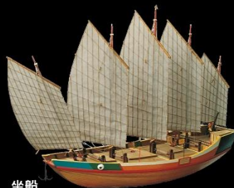
坐船 長度：24/67.9(丈/公尺) 寬度：9.4/26.6(丈/公尺) 深度：5(呎水；公尺) 排水量：4033(噸) 載重量：2000(噸)
