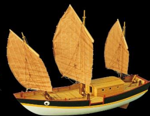
戰船 長度：18/50.9(丈/公尺) 寬度：6.8/19.2(丈/公尺) 深度：4(呎水；公尺) 排水量：1703(噸) 載重量：850(噸)
