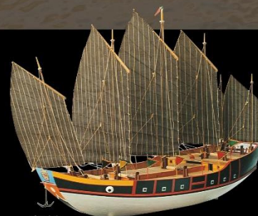
糧船 長度：28/79.2(丈/公尺) 寬度：12/34(丈/公尺) 深度：6(呎水；公尺) 排水量：7081(噸) 載重量：3500(噸)
